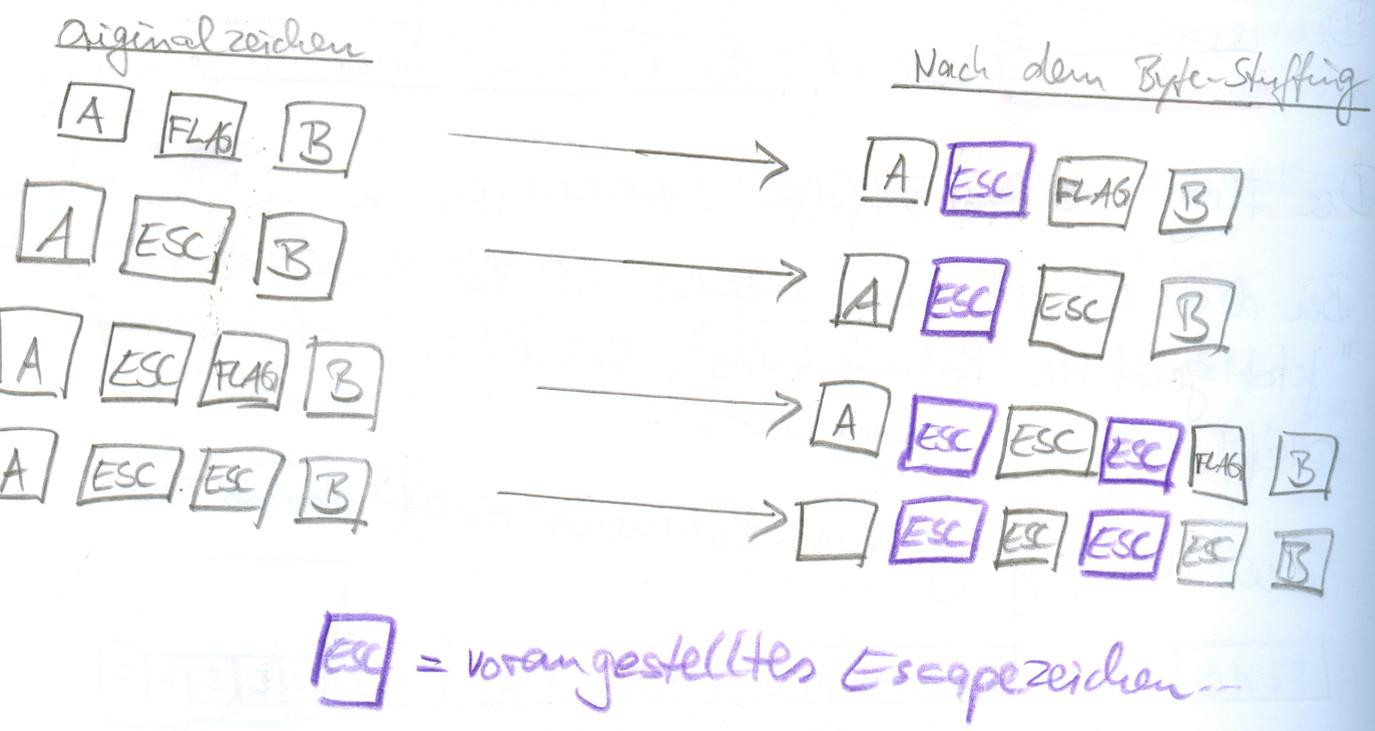
Dieses "Byte-Stuffing" (also Byte-stopfen) hat einen kleinen Nachteil: Es ist auf Rahmen einer Bytegröße reduziert. Es gibt aber auch Codes, die mehr als nur ein Byte (also 8 Bit) lang sind. Daher suchte man nach einer anderen Methode, um Zeichen in beliebiger Länge zu unterstützen. Das "Bit-Stuffing" war geboren...
